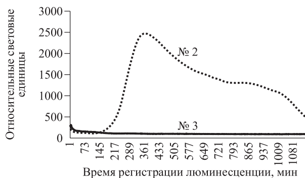
Рис. 4. Динамика люминесцентного сигнала образцов древесины объектов № 2 и 3 (ноябрь 2015 г.).
